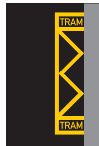
V 11b Zastávka tramvaje
